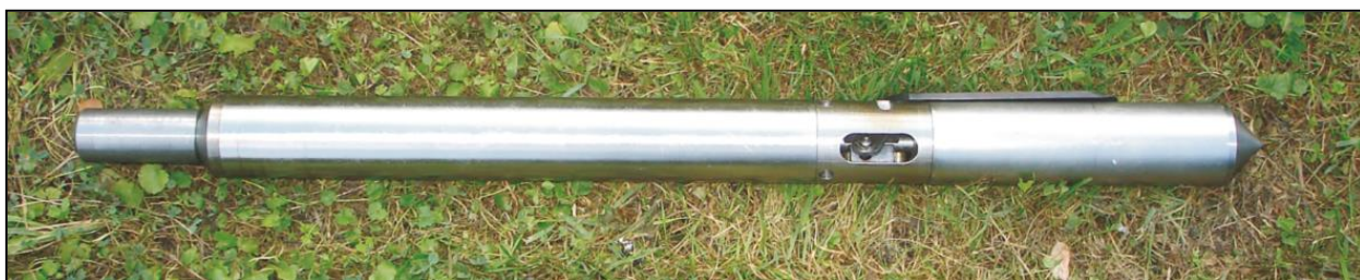
Рисунок 9 – Скважинный 3-х компонентный зонд с прижимным устройством
