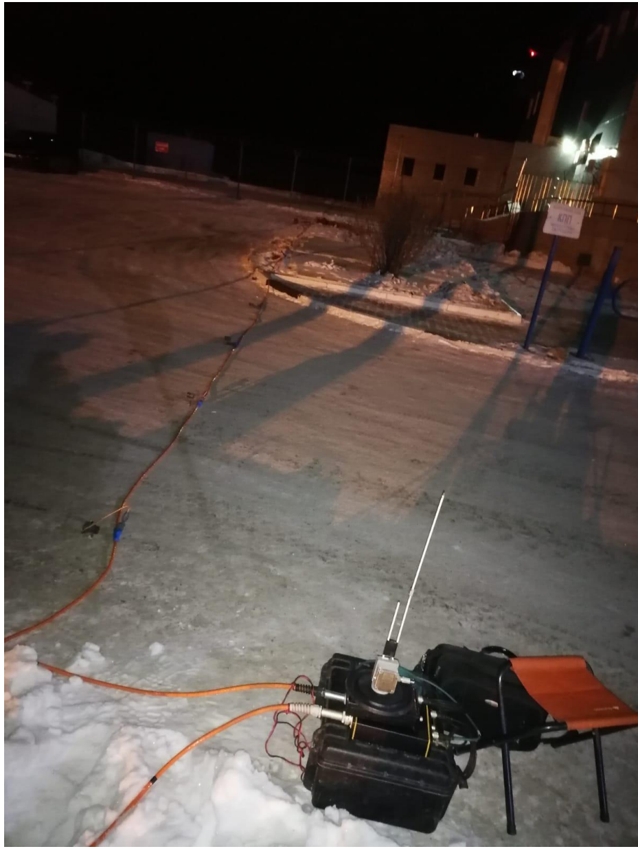
Рис. 6. Выполнение полевых сейсморазведочных исследований на территории АВК
